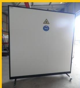
Les panneaux de protection Laser sont conformes aux marquages normalisés : DIR A B6 selon la norme EN 12254. L'absence de fente entre les panneaux est garantie. Plusieurs options de supports sont également proposées : pieds ou roulettes de support permettent les déplacements dans différents lieux. Plusieurs architectures sont possible (En L, en U, création d'un sas ou d'une cabine fermée, etc...).
