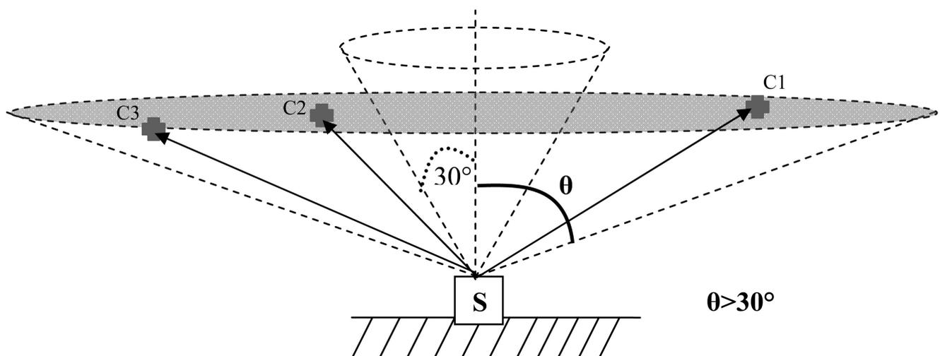
(Fig. 2 : tirs sur cible matérielle fixe opaque et non réfléchissante pour tout rayon formant un angle ( $\theta$ ) supérieure à  $30^\circ$  ; S = source du laser ; C1, C2, C3 = cibles fixes opaque et non réfléchissantes).
